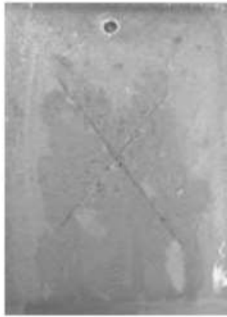
A: CrVI passivate film on zinc
