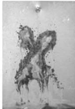
B: CrIII passivate film on zinc
